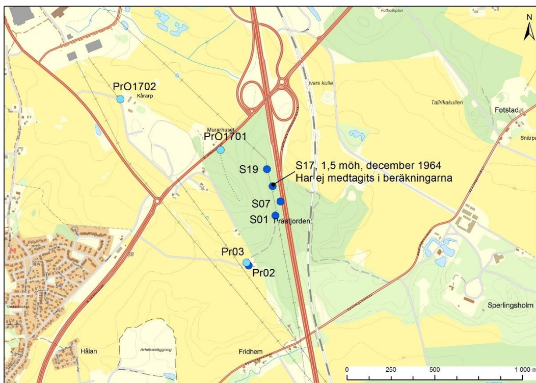
Figur 1 Observationsrör och grundvattennivåer som använts vid transporttidsberäkningarna för Prästjorden då ingen infiltration pågått.
